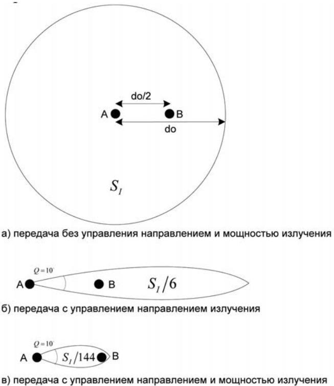
Рис. 3. Преимущества адаптации направления и мощности излучения
