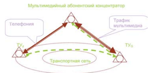
Рис. 5. Варианты прохождения потоков трафика телефонии в сети доступа NGN
