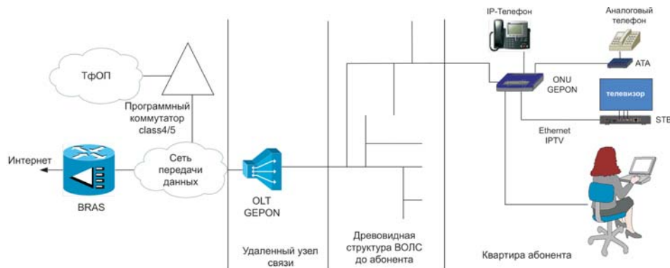
Рис. 1. Реализация ШПД на основе GEPON
