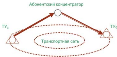
Рис. 1. Вариант раздельного прохождения потоков трафика телефонии на уровне доступа NGN
