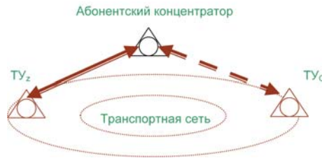
Рис. 2. Вариант использования пучков связи двустороннего занятия на уровне доступа сети NGN
