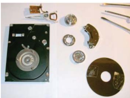
Рис. 11. Составные части многодискового винчестера ST3750640A
