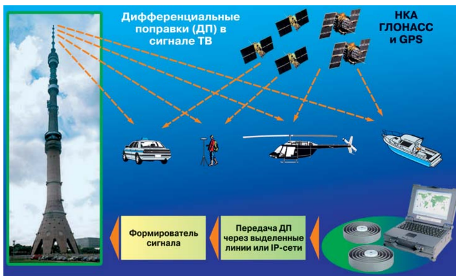
Схема построения регионального функционального дополнения
