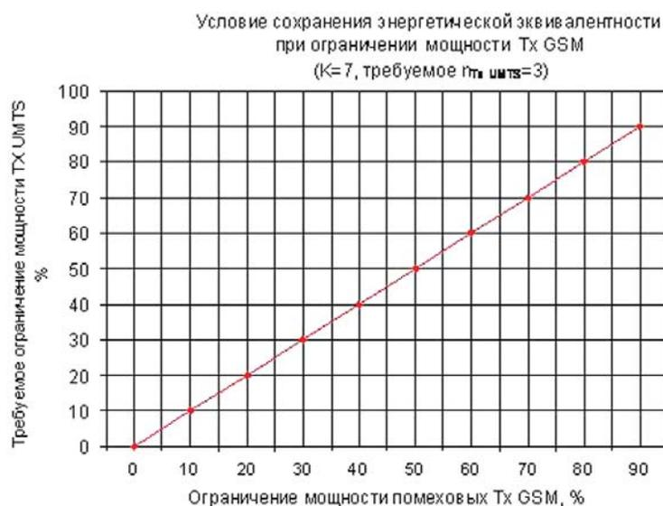
Рис. 4. Выполнение условия энергетической эквивалентности за счет ограничения мощности передатчиков UMTS
