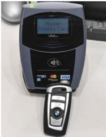
Ключ от автомобиля, кроме стандартного функционала (центральный замок, иммобилайзер ит.д.), также обеспечивает связь с мобильным устройством через интерфейс NFC, что позволяет использовать мобильный телефон (с поддержкой NFC) для отображения более подробной информации о статусе и местоположении автомобиля. Данный ключ можно использовать для осуществления бесконтакт-
