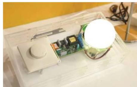
LED-светильники позволяют экономить до 80% электроэнергии по сравнению с обычными лампами накаливания. Решение позволяет плавно управлять светом без мерцания и шумов. Схема содержит встроенный модуль, позволяющий работать с недорогими TRIAC диммерами. В основе схемы лежит микросхема SSL2102, ее схемотехника дает возможность реализации различных видов подключения: изолированный, неизолированный, повышающий, понижающий.
