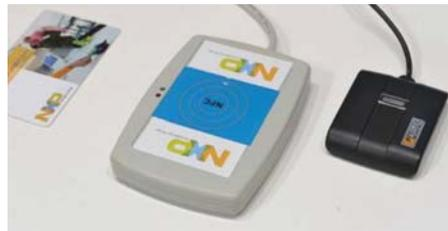
Концепция для использования в системах контроля доступа демонстрирует возможность идентификации отпечатка пальца путем сравнения конфиденциальной информации (отпечаток пальца) в безопасном устройстве — непосредственно внутри карты на базе микросхемы семейства SmartMX, без необходимости обращения в специальные процессинговые центры. Это позволяет избежать значительных затрат по построению высокозащищенной инфраструктуры хранения и обработки конфиденциальных данных и проводить сравнение от-
