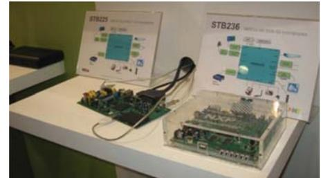
Полупроводниковая платформа STB225 для телевидения высокой четкости (ТВЧ) с реализованным функционалом PVR LAN/USB, Time Shift и Media Player. На базе данного решения отечественные производители цифровых приставок получают уникальную возможность в сжатые сроки запустить массовое производство оптимизированного по цене MPEG4 HD изделия с богатым функционалом, который реализован на уровне ПО при активном участии российских разработчиков.
