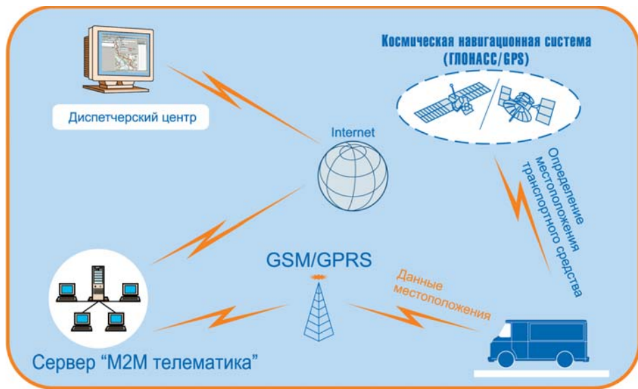
Схема работы автоматизированной системы мониторинга и управления транспортом BN-City®
