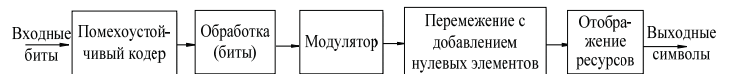
Рис. 8. Структурная схема системы NOMA с перемежением и добавлением нулевых элементов на уровне символов
