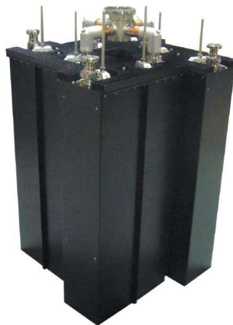
Рис. 4. Общий вид комбайнера по схеме «Звезда»
