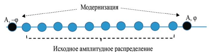
Рис. 3. Принцип модернизации амплитудного распределения Дольфа-Чебышева
