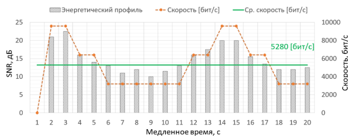
Рис. 6. Энергетический профиль канала и доступные скорости передачи данных для сеанса 2, при актуализации эквалайзера только на 1 секунде сеанса
