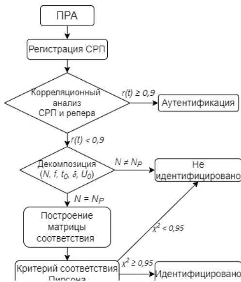
Рис. 6. Методика проведения идентификации РЭУ радиосенсорным методом
