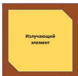
Рис. 4. Излучающий элемент с круговой поляризацией
