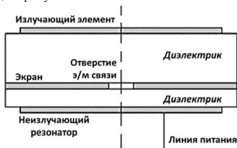
Рис. 3. Питание ИЭ по принципу щелевой антенны
