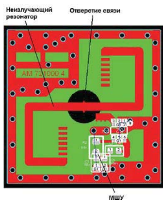
Рис. 5. Пример размещения МШУ в модуле ЭИ [26]
