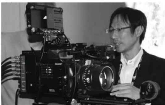
Рис. 1. Камкордер 8С-В60А компании Sharp с 40-минутной записью на карту памяти видеосигнала с разрешением 8К
