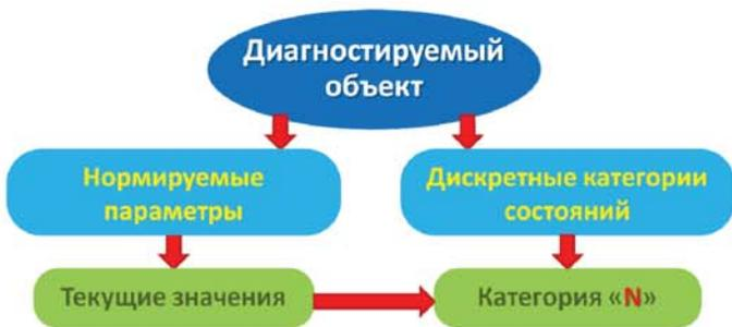
Рис. 1. Определение текущей категории состояния объекта
