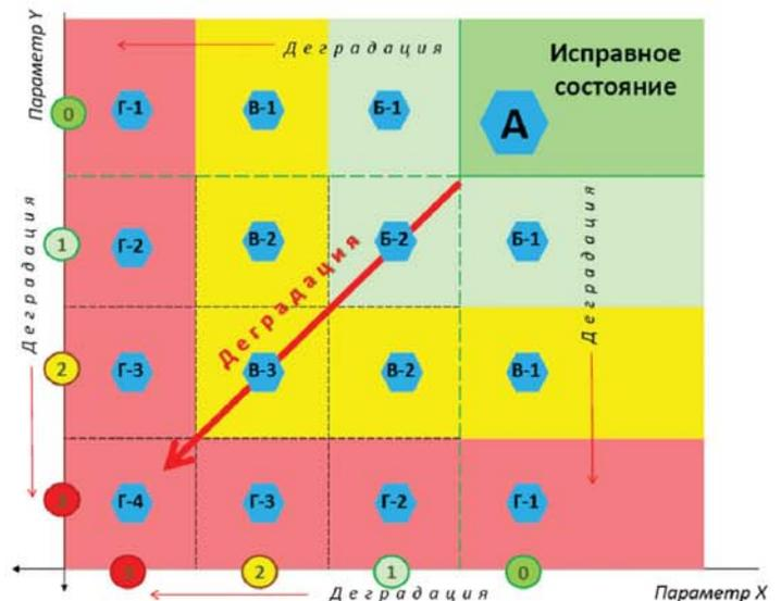
Рис. 2. Пример двумерной модели состояния объекта
