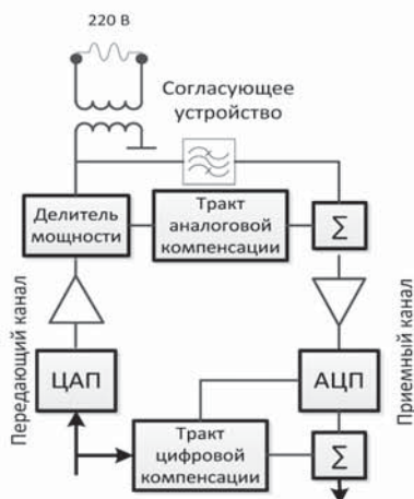
Рис. 1. Общая концепция построения полнодуплексной системы передачи данных по цепям питания
