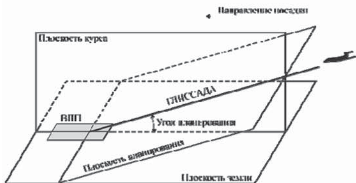
Рис. 3. Схема посадки самолета по курсо-глиссадной системе
