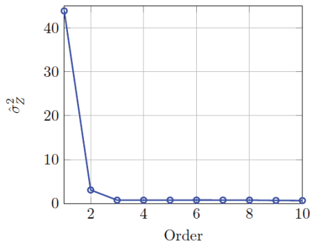
Рис. 2. Расчетная дисперсионная кривая полиномиальной модели с порядком p
