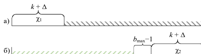
Рис. 1. а) Расположение информационной совокупности в начале кодового слова; б) Расположение информационной совокупности в конце кодового слова
