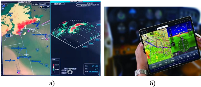
Рис. 6. Совместное использование метеонавигационной информации, получаемой через систему NEXRAD США) и с бортовой РЛС GWX-70 (рис. 6а) и отдельное использование технологии NEXRAD (рис. 6б)
