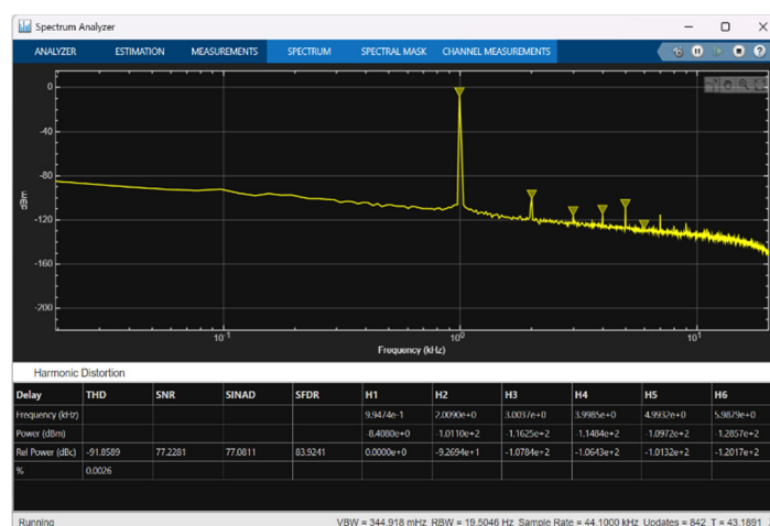
Рис. 7. Спектр выходного канала цифрового двойника аудиомодуля трехполосного параметрического эквалайзера, зарегистрированный с помощью инструмента Spectrum Analyzer системы ВГЭ Simulink.
