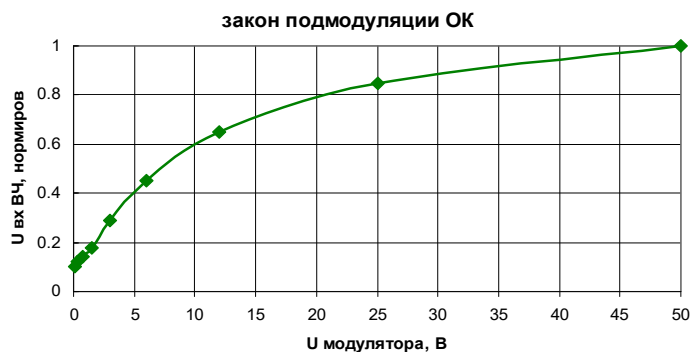
Рис. 13. Оптимальный закон подмодуляции ВЧ возбуждения ОК, обеспечивающий линейность его модуляционной характеристики
