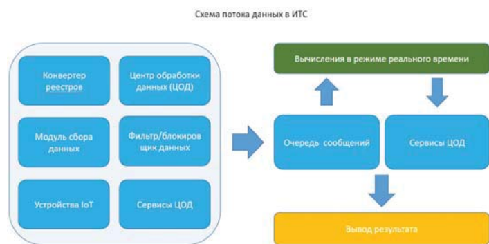
Рис. 3. Схема потока данных в ИТС
