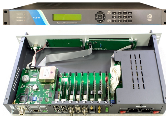
Рис. 8. Внешний вид сервера синхронизации времени типа ССВ-1Г
