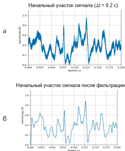
Рис. 9. Начальный участок ( \Delta t = 0,2 \text{ с} ) сигнала (а) до фильтрации с частотой среза 300 Гц и (б) после фильтрации
