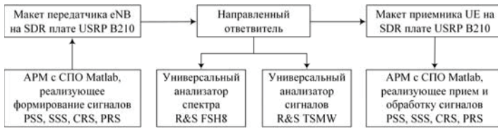
Рис. 12. Схема лабораторных испытаний передатчика опорных сигналов LTE
