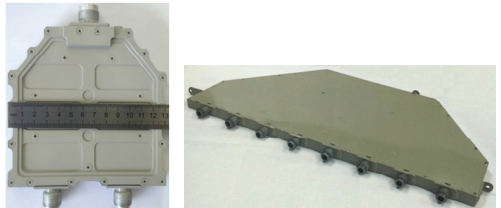
Рис. 7. Кольцевые сумматоры L-диапазона частот: двухканальный (слева) и восьмиканальный (справа)
