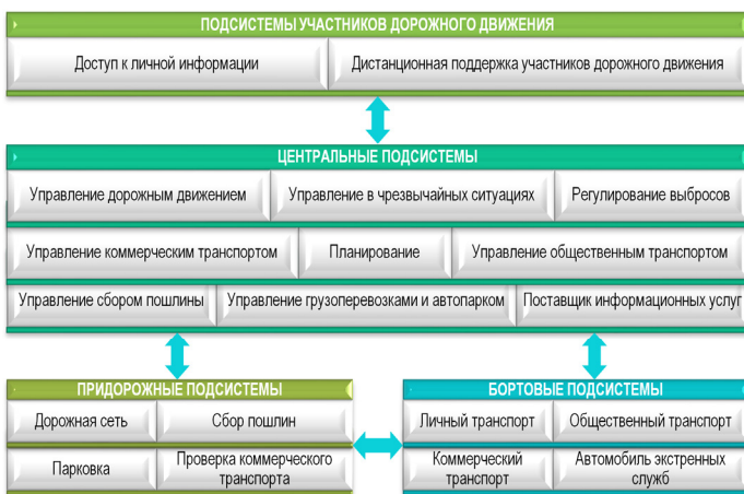
Рис. 3. Архитектура связи К-ИТС
