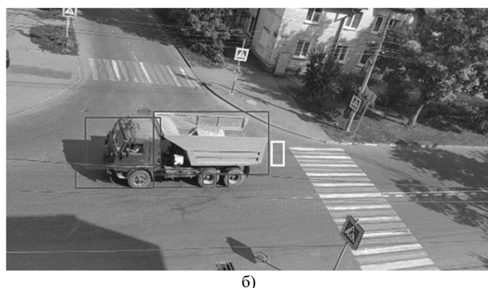
Рис. 1. Выделение кадров начала и окончания пересечения движущимся автомобилем области фиксации: а) – проезд автомобиля контрольной области фиксации; б) – освобождение автомобилем контрольной области фиксации
