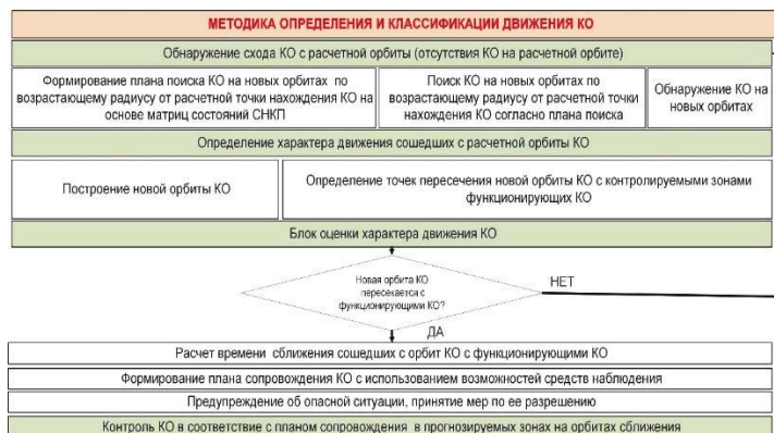
Рис. 6. Рекомендации по контролю КО при обнаружении его схода с расчетной орбиты
