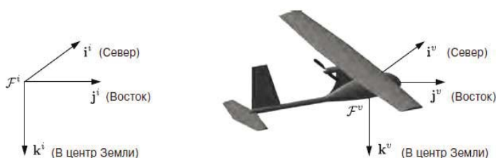
Рис. 2. Система координат летательного аппарата \mathcal{F}^v
