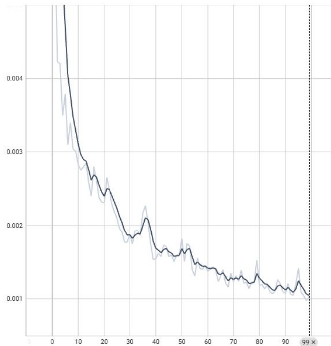
Рис. 9. Значения ошибки MSE при обучении модели нейронной сети на основе 8 блоков GRU
