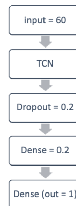
Рис. 21. Структура модели нейронной сети на основе TCN
