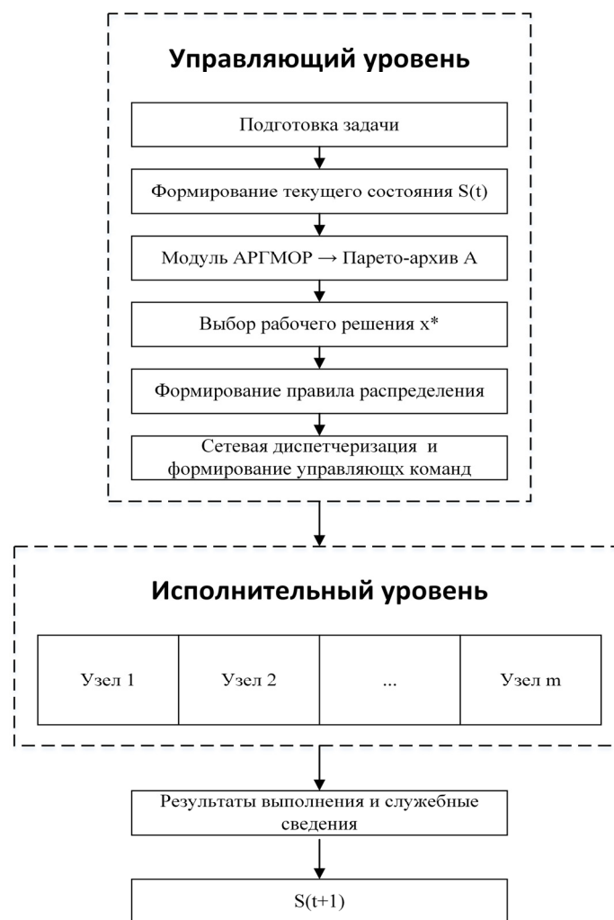
Рис. 2. Архитектура применения АРГМОП в распределённой вычислительной сети
