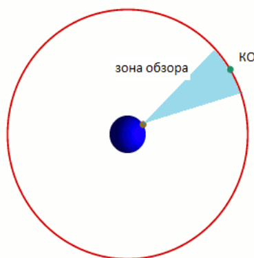
Рис. 1. Орбита КО и конус зоны действия наземного средства наблюдения
