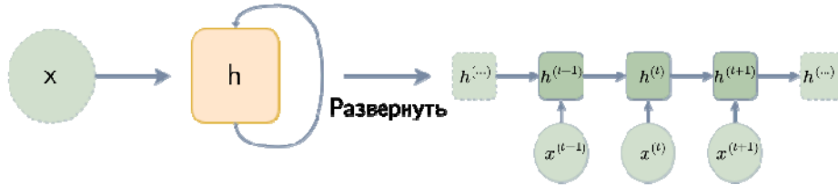
Рис. 10. Развернутая рекуррентная сеть без выходов
