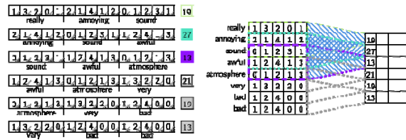
Рис. 4. Применение свертки для извлечения признаков из текстов
