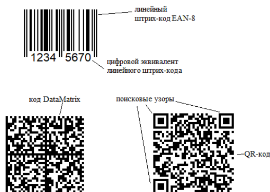
Рис. 1. Пример линейного и двухмерных штрих-кодов
