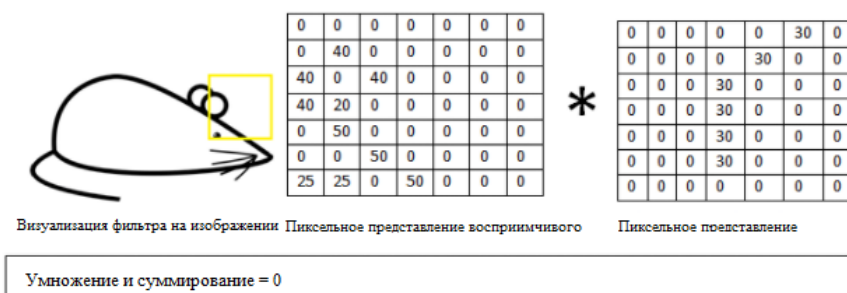
Рис. 4. Фильтр не смог определить кривую, на которую не был обучен свёрточный слой
