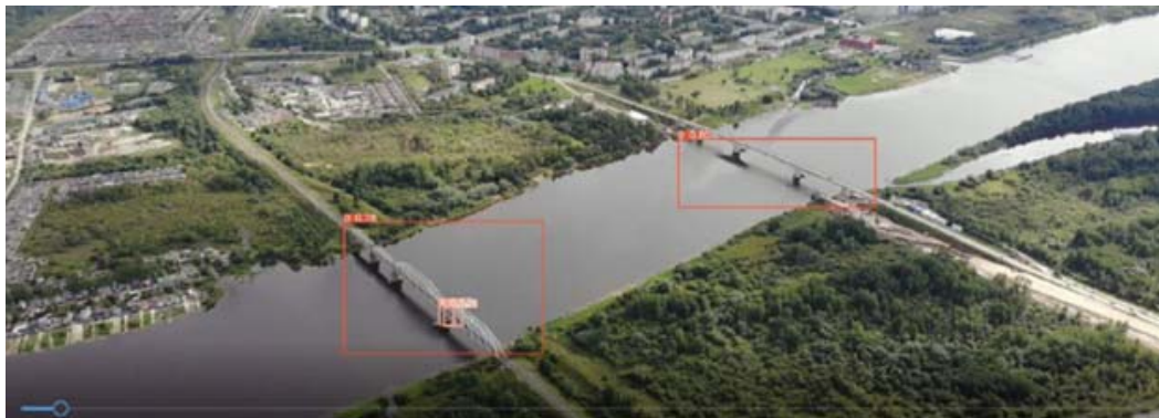
Рис. 4. Выделение опор произвольного моста
