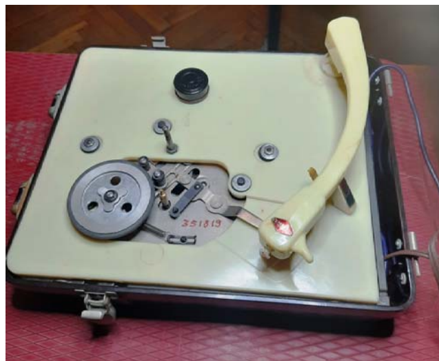
Рис. 6. УПМ-1 со снятым диском, виден серийный номер и состояние механизма привода диска.
