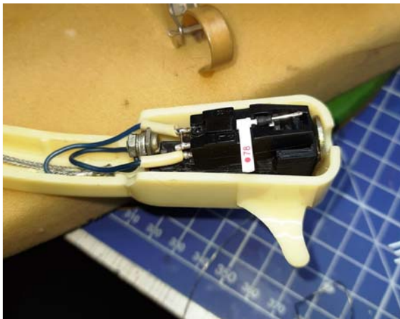
Рис. 13. Звукосниматель установлен в тонарм и подключены провода для предварительной настройки.
