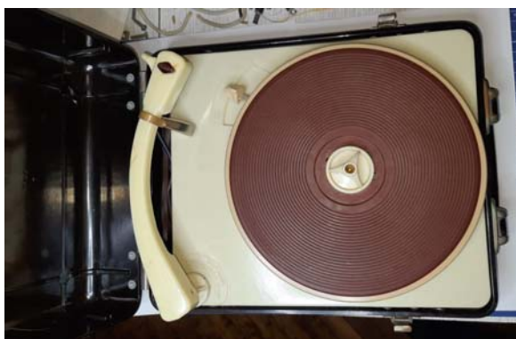
Рис. 21. УПМ-1 в открытом корпусе, тонарм зафиксирован в походном положении, провода убраны в нишу.
