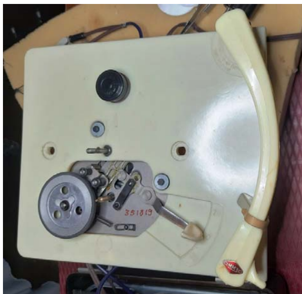
Рис. 16. Установленный на панель корпуса двигатель с переключателем скорости, все узлы смазаны. Стойка тонарма установлена в правильное положение.
