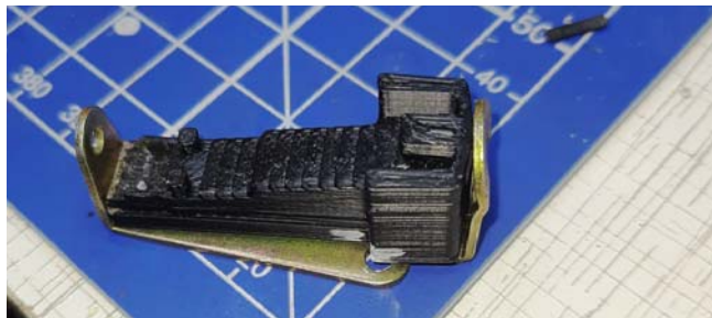
Рис. 12. Корпус основания звукоснимателя подогнан под площадку тонарма.
