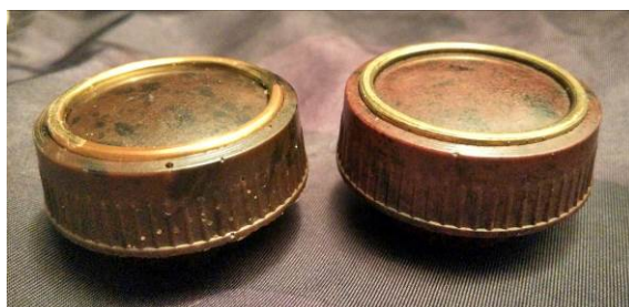
Рис. 1. Ручка от приёмника, изготовленная методом отливки, (слева) и оригинальная ручка
