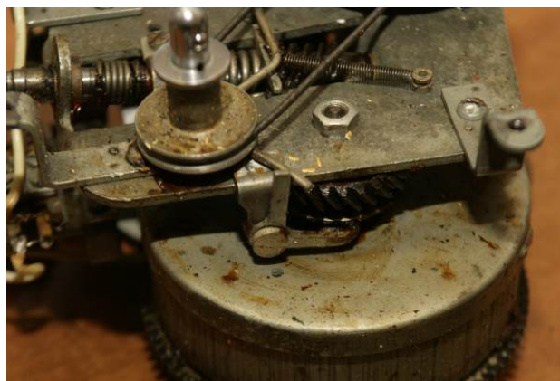
Рис. 5. Конструкция ранней версии указателя остатка завода пружины
