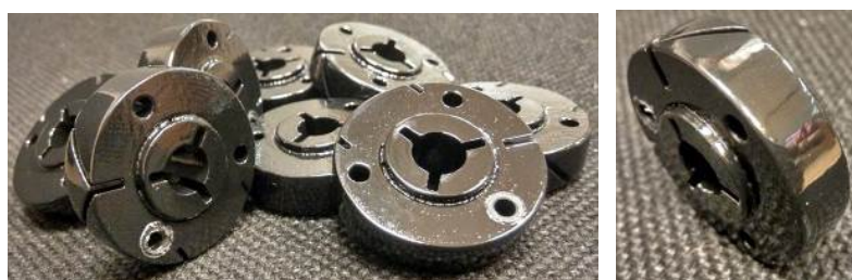
Рис. 7. Готовые детали после обработки ацетоном
