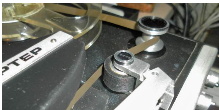
Рис. 3. Прижимной ролик в магнитофоне, напечатанный FLEX пластиком
