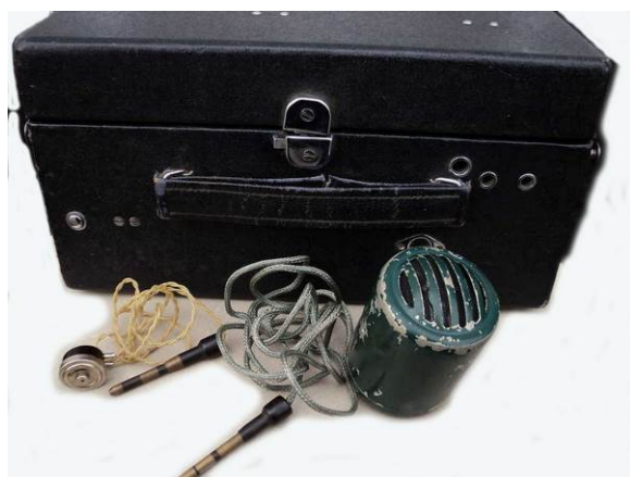
Рис. 8. Микрофон МДМ-2 и штекера переключения режимов
