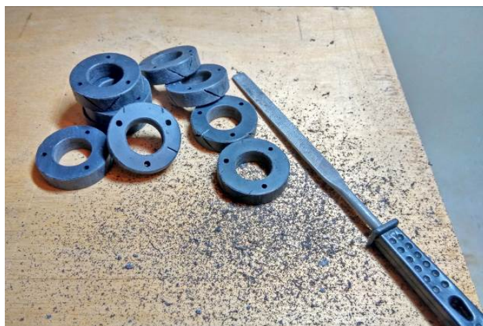
Рис. 6. Обработка поверхностей деталей надфилем
