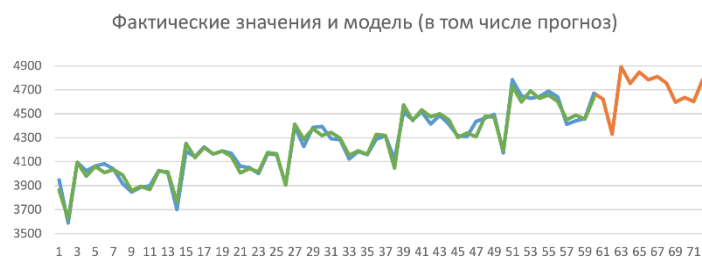
Рис. 5. Фактические значения и модель ARIMA прогноза колебаний вагонопотоков по стыковому пункту Петровский Завод ЗаБЖД
