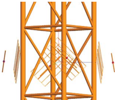
Рис. 20. Призма 2500 x 2500. Панели вариант 2. Панели установлены на поясах
