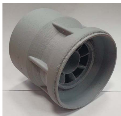
Рис. 2. Направляющая часть турбинного насоса, изготовленная по технологии FDM
