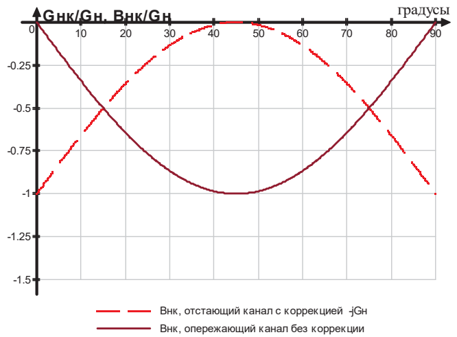
Рис. 4. Нормированные реактивные каналные проводимости. В отстающем канале добавлена корректирующая индуктивная проводимость B_{Lкк} = -jG_n ; опережающий канал без коррекции
