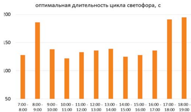
Рис. 5. Изменение оптимальной длительности цикла светофорного регулирования в течение дня
