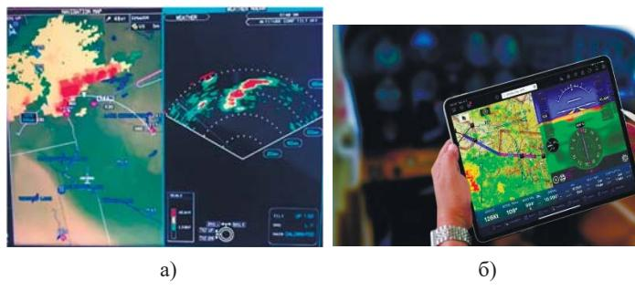
**Рис. 6.** Совместное использование метеонавигационной информации, получаемой через систему NEXRAD США и с бортовой РЛС GWX-70 (рис. 6а) и отдельное использование технологии NEXRAD (рис. 6б)
