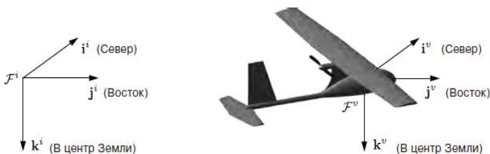
Рис. 2. Система координат летательного аппарата \mathcal{F}^v
