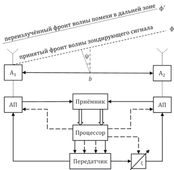
Рис. 3. Структура постановщика помехи ретрансляционного типа
