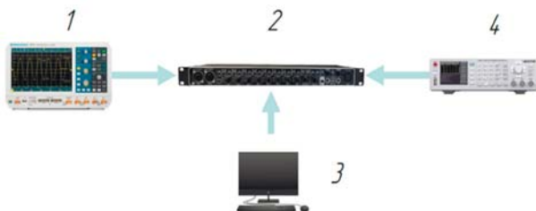
Рис. 5. Схема экспериментального стенда киберфизической SPICE-эмуляции сигнальных аудиомодулей: 1 – осциллограф RTB2002, 2 – аудиоинтерфейс UMC1820, 3 – персональный компьютер, 4 – генератор сигнала HMF2550
