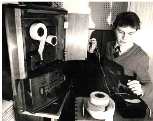
Рис. 2. Инженер фирмы «Мелодия» за восстановлением аппарата «Говорящая бумага» ГБ-6А
