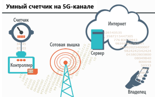
Рис. 3. Логика работы с интеллектуальным счетчиком
