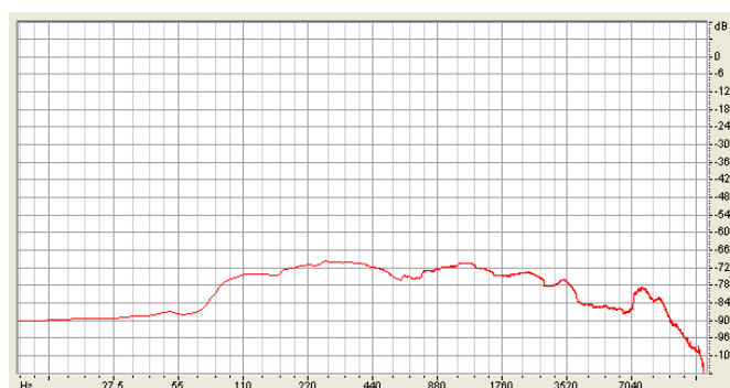
Рис. 6. Спектр сигнала ошибки при компактном представлении СЗВ
