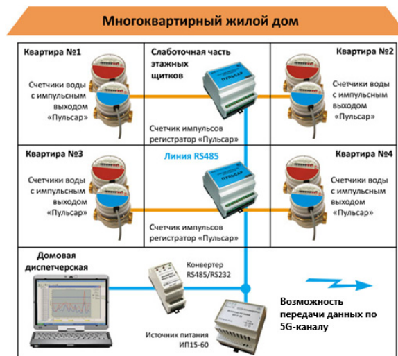
Рис. 2. Схема подключения и использования умных счетчиков
