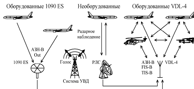
Рис. 4. Взаимодействие между воздушными судами, как оснащенными, так и не оснащенными АЗН-В
