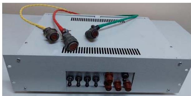
Рис. 12. Блок питания в собранном виде с соединительными кабелями. В передней и задней панели сделаны прямоугольные отверстия под органы управления и разъёмы. Включение передатчика производится подъёмом четырёх тумблеров вверх, по очереди, слева-направо, выключение в обратном порядке. Справа расположены держатели предохранителей, а справа-вверху – переключатель выбора значения анодного напряжения 625 или 1250 вольт
