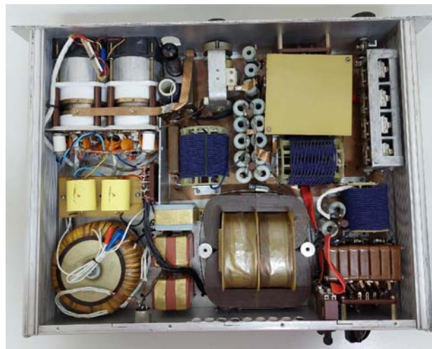
Рис. 9. Компоновка верхнего этапа передатчика. Слева-направо, сверху-вниз в два ряда
