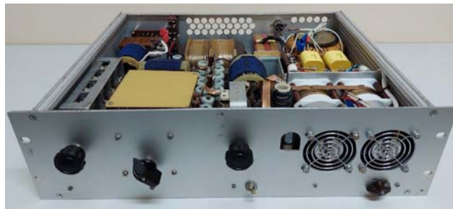
Рис. 10. Вид на передатчик спереди-сверху. Регулировки, слева направо: Настройка выходного конденсатора второго П-контура. Переключатель «Связь с антенной». Настройка анодного конденсатора первого П-контура. Снизу – переключатель индикатора «Ток антенны – Модуляция». Окошко индикатора «Зелёный глаз». Выходные решётки вентиляторов радиоламп. Снизу - переключатель рабочих частот
