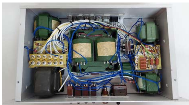
Рис. 11. Расположение элементов внутри блока питания понятно из фотографии. Четыре трансформатора, два дросселя, три платы с конденсаторами, резисторами и стабилитронами. Угловой радиатор для мостовых выпрямителей КЦ404А. Монтаж выполнен на горизонтальном дюралево шасси. Оно же является теплоотводом для мостовых выпрямителей
