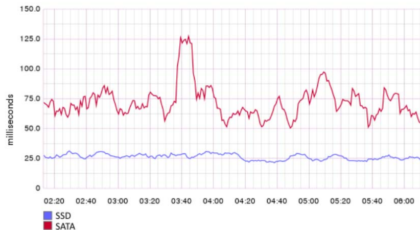
Рис. 3. График результатов затрат времени на решение задачи отправки блока на узлы Flume через файловые каналы
