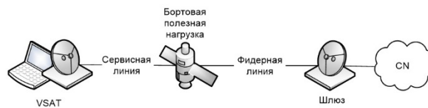
Рис. 1. Сценарий с использованием спутниковой платформы как ретранслятора
