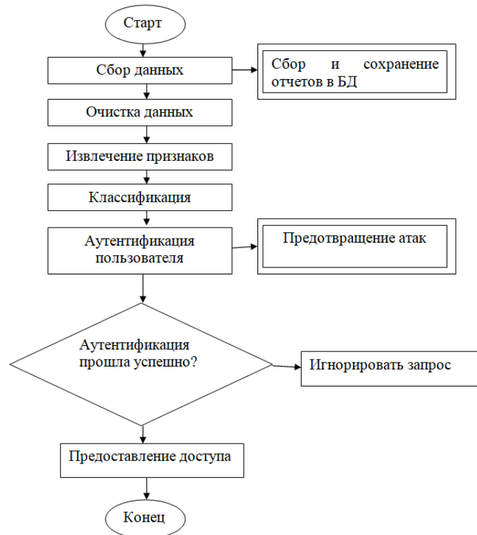
Рис. 5. Метод обнаружения SQL-инъекций с использованием глубокого леса
