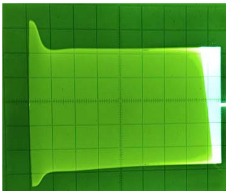
Рис. 10. Компрессор с оптроном (рис. 4). Осциллограмма импульсной характеристики (5 ms/клетка, 50 мВ/клетка) с постоянной времени 2 ms при C7 = 0.47 мкФ.
